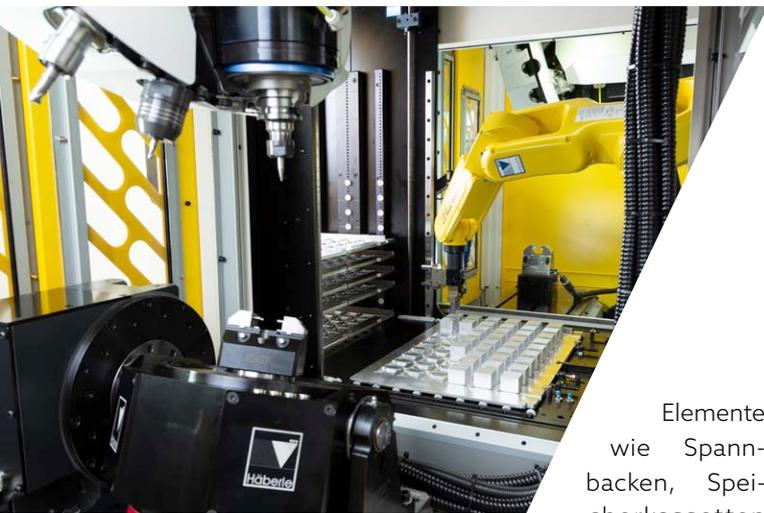
Mit dem 5-Achs-Drehtisch lassen sich die eng tolerierten Maße für Käfer-Messuhren in einer Aufspannung bearbeiten.
