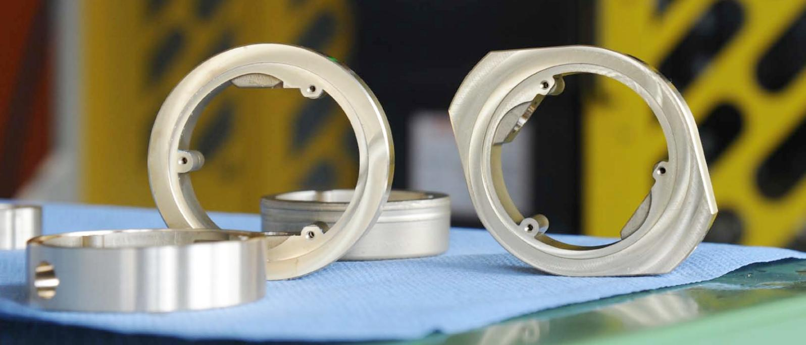
Präzise Bearbeitung der Komponenten ist entscheidend für die Genauigkeit der Messuhren.
